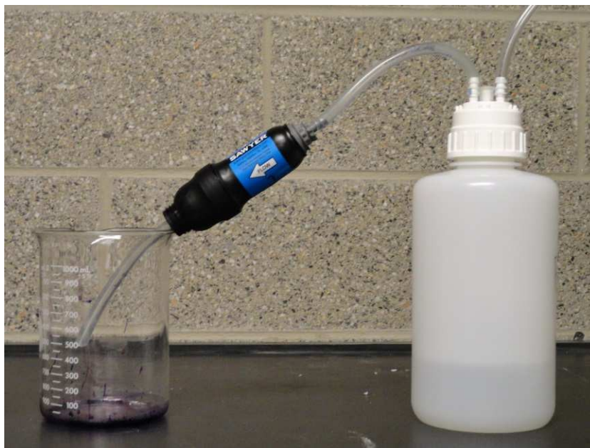
Figura 1. Dispositivo de presurización para forzar el agua de prueba a través del filtro Sawyer.
